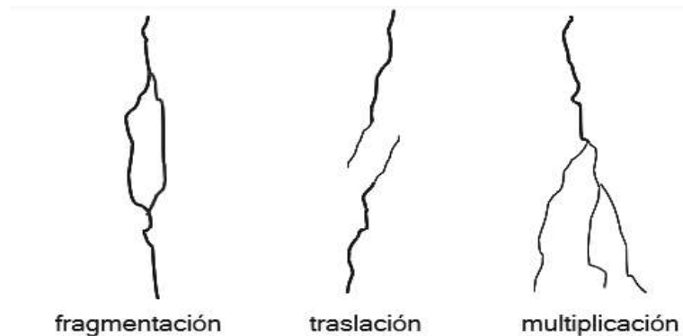
Figura 17. Patrón de fisuras influenciado por las fibras de acero
