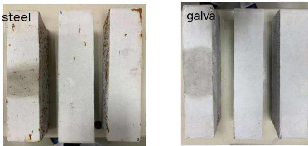
Figura 14. Superficie de panel reforzado con fibra de acero brillante (izquierda) versus superficie con fibra galvanizada (derecha) después de 360 horas en cámara salina
