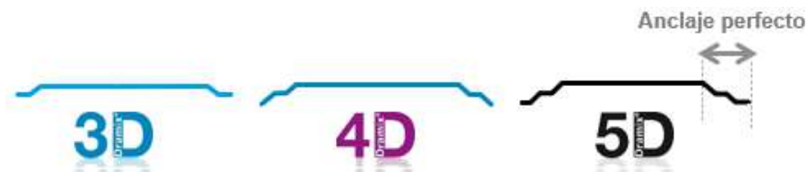
Figura 3. Diferentes tipos de anclaje de fibras de acero
