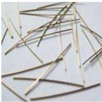
Fibra corta, sin anclaje, suelta
