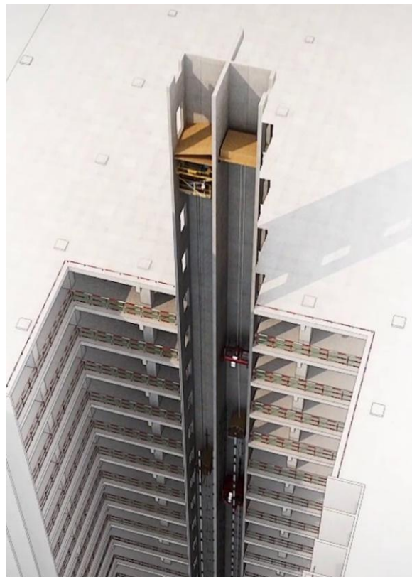
Figura 9.5-1. Detalle del Crash Deck para montaje faseado
