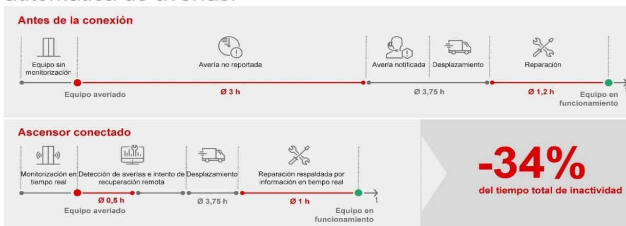
Figura 9.6. Esquema de referencia de Schindler de funcionamiento del mantenimiento predictivo
