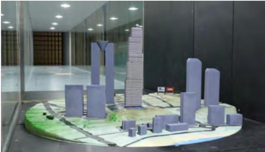
Figura 8.7 Fotografía del modelo a escala (1:300) donde se incluye TM Tower y su entorno próximo. El modelo fue instrumentado con un total de 386 tomas de presión y ensayado desde 36 ángulos diferentes.
